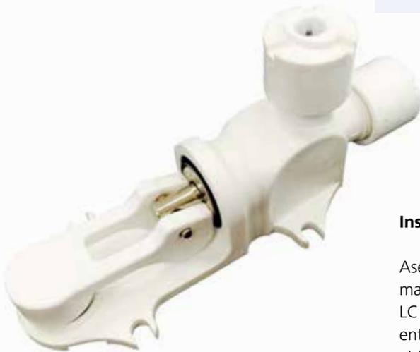
La protección contra fugas LC cierra la entrada de agua tras la válvula de ángulo en caso de producirse una escape de agua. Para ello integra una pequeña pastilla de tejido que absorbe el agua y después acciona la válvula de la LC e interrumpe la entrada de agua. La pastilla de tejido se puede sustituir cuantas veces se quiera para volver a usar la LC con una nueva pastilla después de una fuga.
